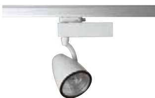
Spot i støbt aluminium med elektronisk forkobling lyskilde er CDM-T sokkel G12, 36° spredning.
