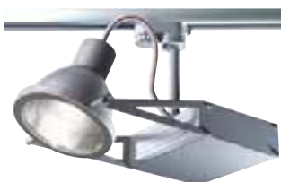
Spot i støbt aluminium med elektronisk forkobling lyskilden er af typen Whiteson SDW-T. sokkel PG12-1. spredningen er 36°.
